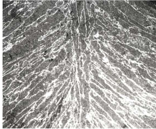
Figure II.3 : Orientation des grains dans la ZF de l'acier X52 lors du refroidissement.
