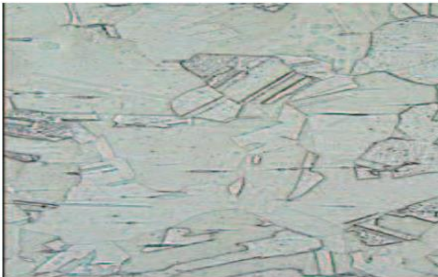
Figure I.1. Structure d'un acier inoxydable austénitique [2].
