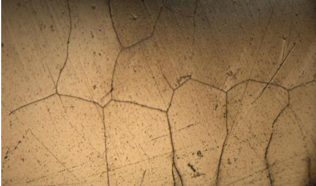
Figure XI.1.. Microstructure de l'acier austénitique après traitement à 1150 C° pendant 30 min.G = 180x
