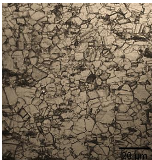
Figure 4-3 : Microstructure de l'acier 316L observée au microscope optique.
