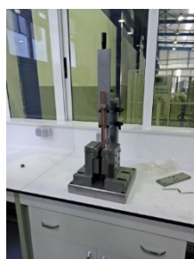
Figure VII.5. Essai de pliage pour le 150mm 2 et le 107mm 2
