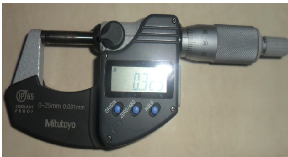
Figure VI.3. Palmer utilisé pour la mesure du diamètre.
