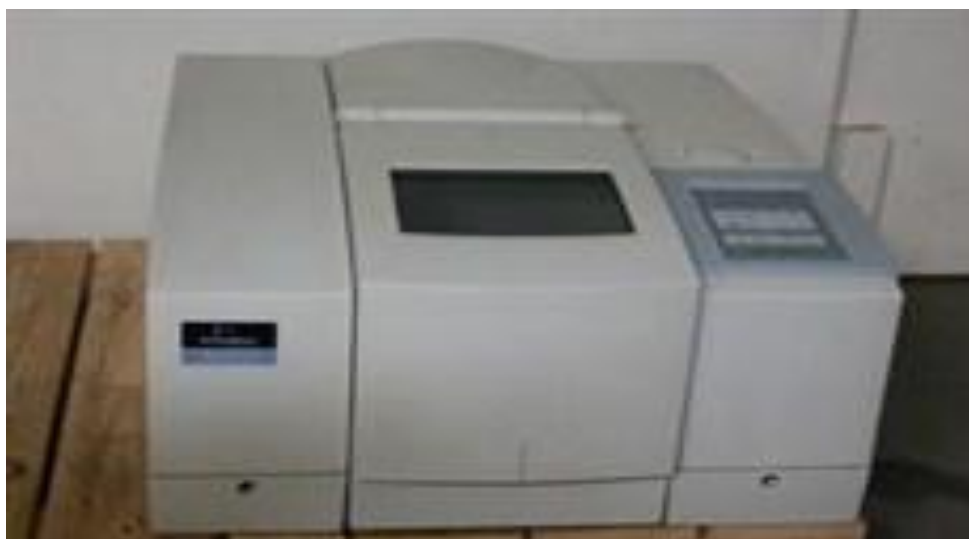
Figure 2.7 : Spectromètre FTIR (Spectrum One)
