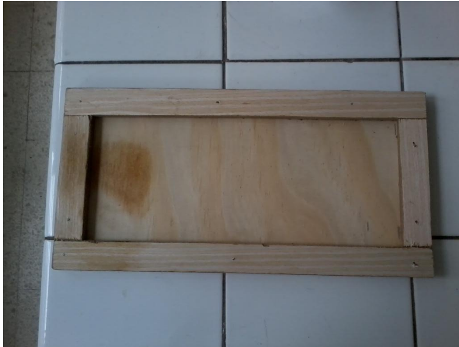
Figure 2.4 : Le moule utilisé pour la préparation des composites
