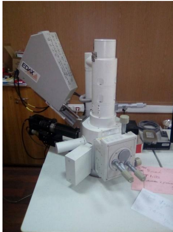
Figure 2.8 : Microscope électronique à balayage (JEOL JSM-6360)
