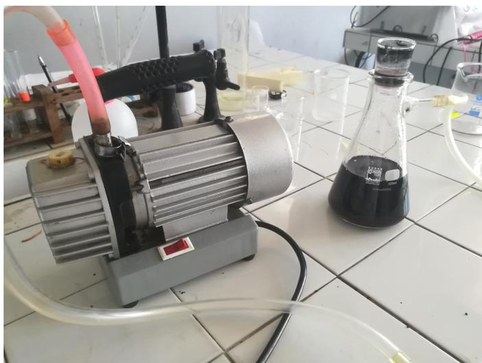
FIGURE 2.3 – Dispositif de filtration sous vide utilisé
