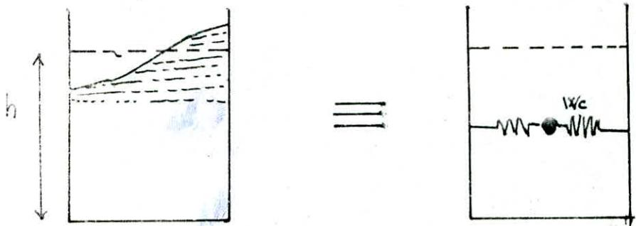
équivalent mécanique des pressions d'oscillation
