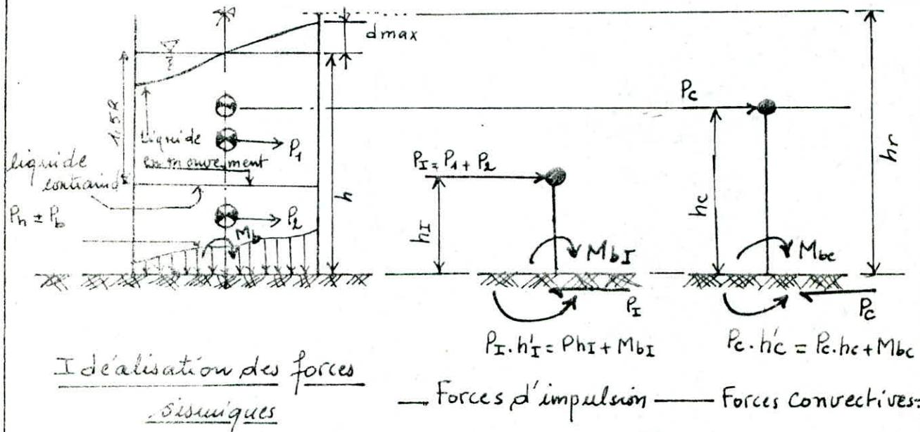
\* Pression verticale sur le fond du réservoir,  $P_h$  est la pression hydrostatique uniforme.
