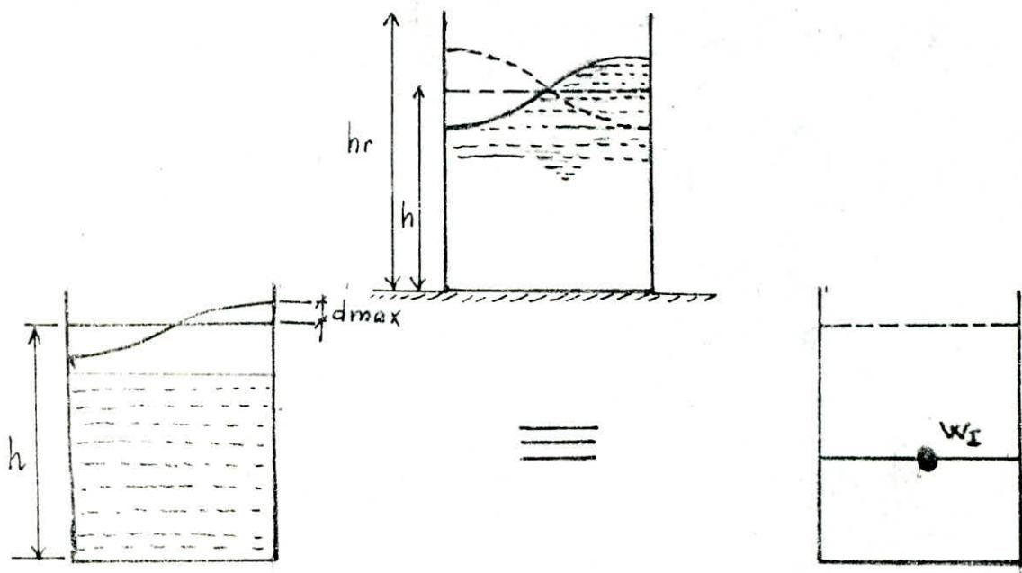
Équivalent mécanique des pressions
