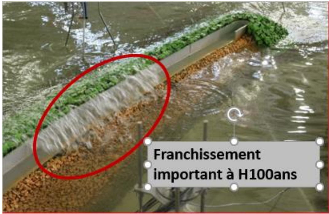
Figure 5.4 : Franchissement important à H100ans à l'essai d'endurance +0,90m qui retombent directement sur la berme du talus intérieur.
