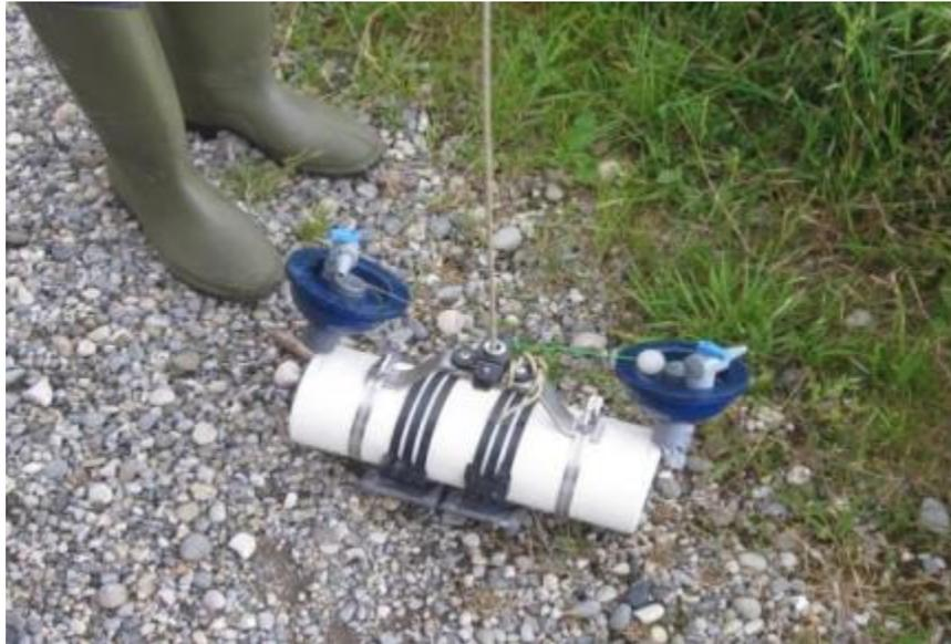
**Figure I.17** : Bouteille de mesure de la suspension (OSR4, 2015-2017).
