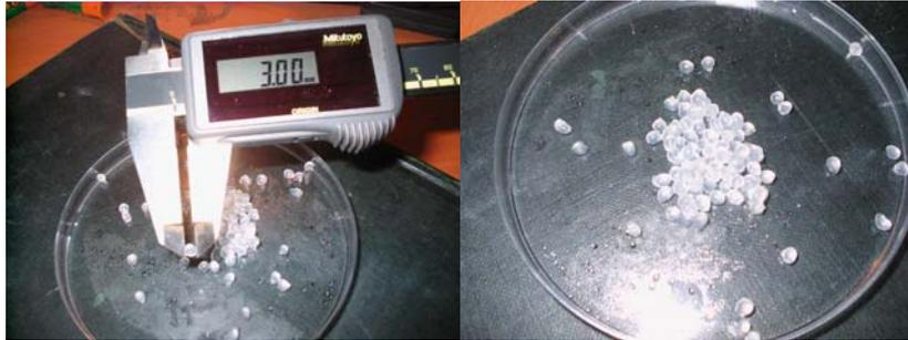
Avec un diamètre d'extrusion de 1 mm, nous obtenons des billes de 4 mm
