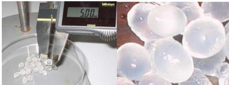
**Figure 39 : Photos représentant l'effet du diamètre d'extrusion sur le diamètre des billes**
