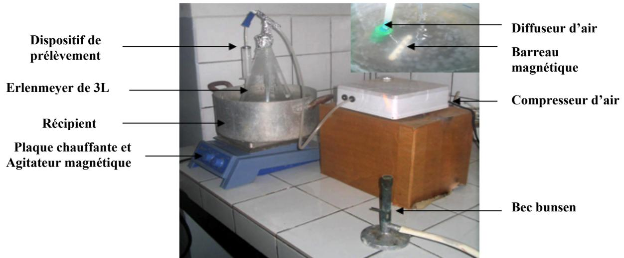
Figure 10 : Photo du dispositif expérimental
