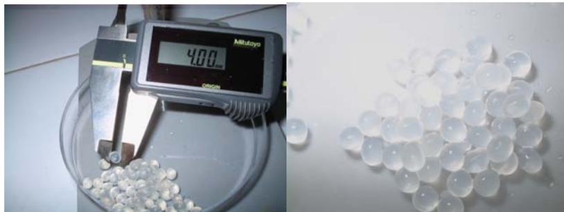
Avec un diamètre d'extrusion de 2,5 mm, nous obtenons des billes de 5mm
