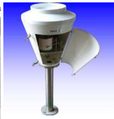
Figure 4- 3 : pluviographe à augets Basculeurs.
