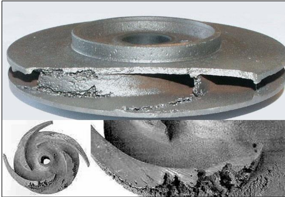
Fig. II.22 turbine endommagée par la cavitation.
