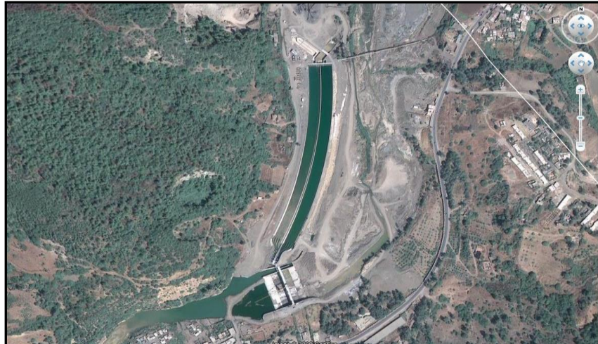
Figure 5.6: prise d'eau sur Oued el Harrach pour alimenter barrage Douera
