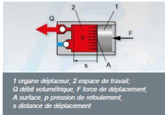
**Figure III.1 : Pompes volumétriques**
