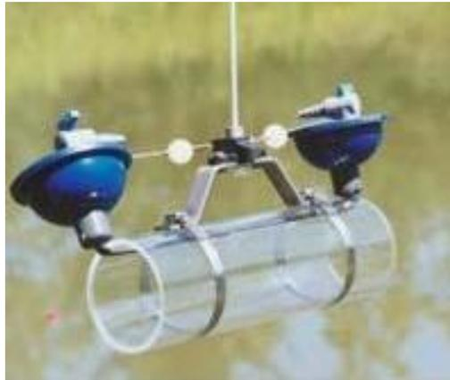
Figure (1,5) : Bouteille d'échantillonnage.
