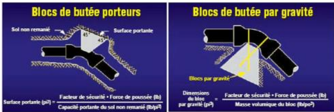
Figure VII. 9: Les butées (Guide DIPRA)
