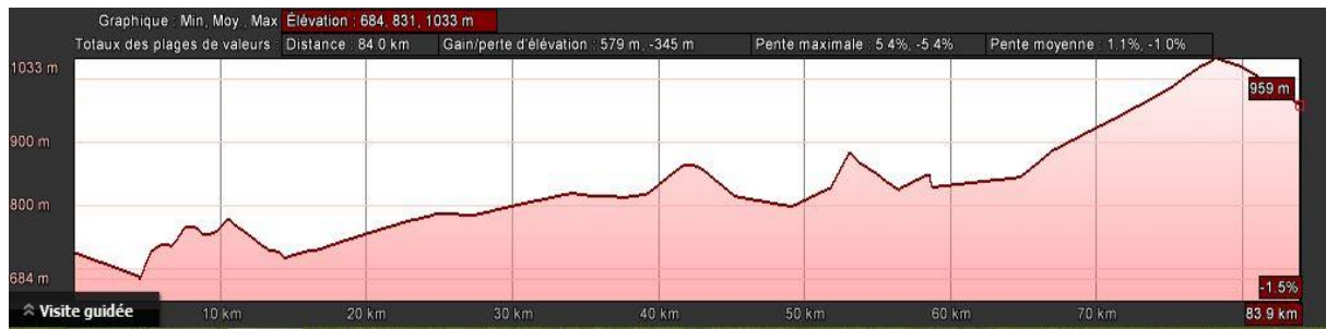
Figure II. 6 : profil en long de la conduite 1, variante 2
