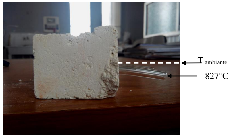
Figure 4. 9: Le ramollissement du verre à 827°C.
