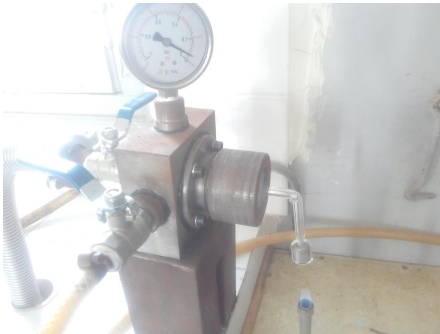
Figure 4. 14: photo de l'opération de dégazage (deuxième étape de l'encapsulation).
