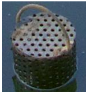
Photo I. 6 : chapeau chinois du bassin API de l'unité de déshuilage du CIS
