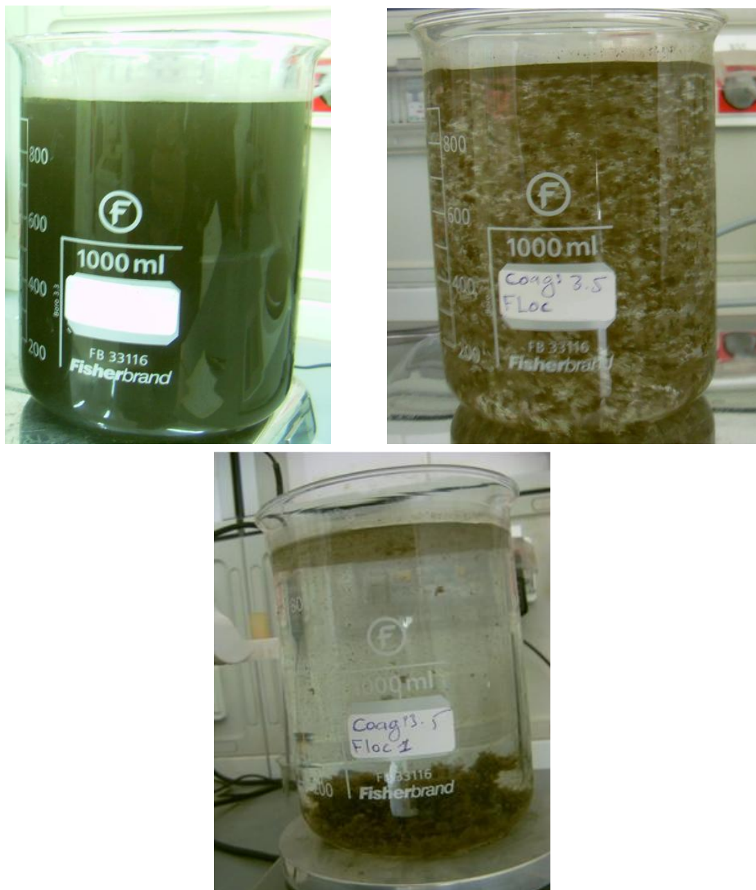
Photo V. 12 : photos de l'échantillon d'eau huileuse pour l'optimisation du coagulant
