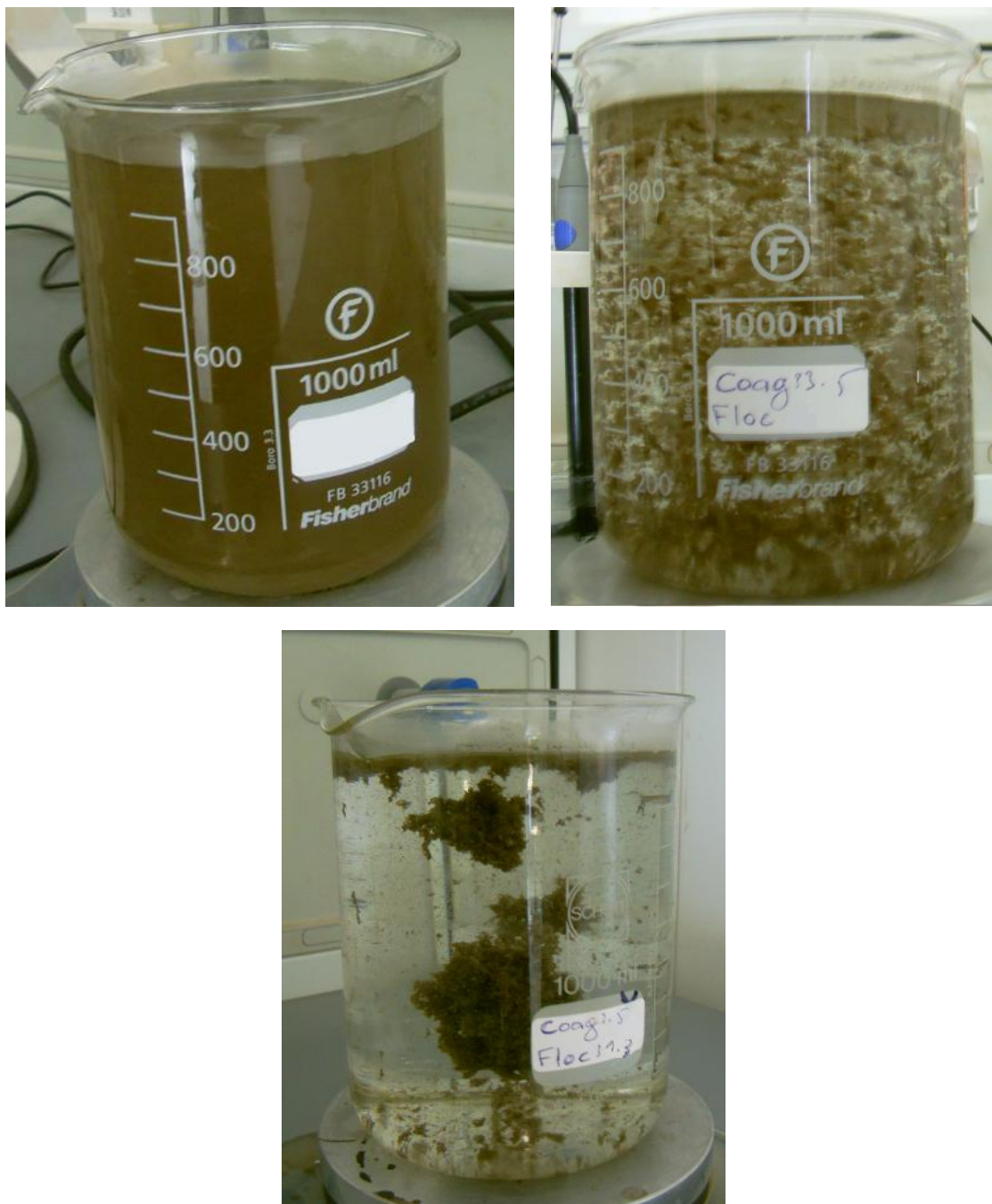
Photo V. 14 : photos de l'échantillon d'eau huileuse avant et après injection des produits chimiques optimaux
