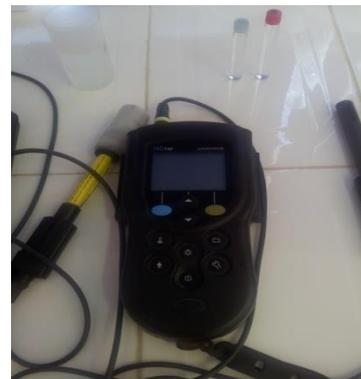
Figure IV.20 : Conductivimètre
