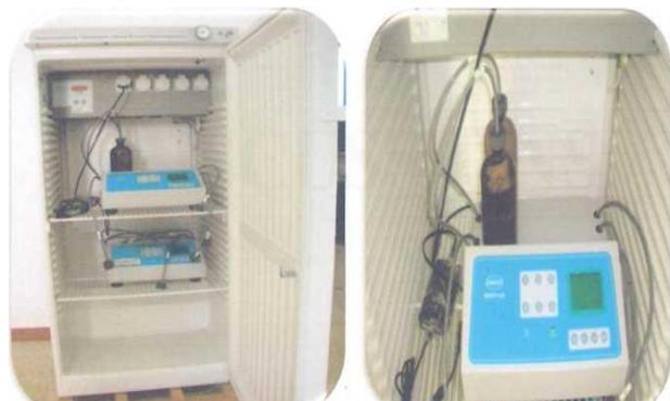
Figure IV.24 : Appareil DBO trak et réfrigérateur
