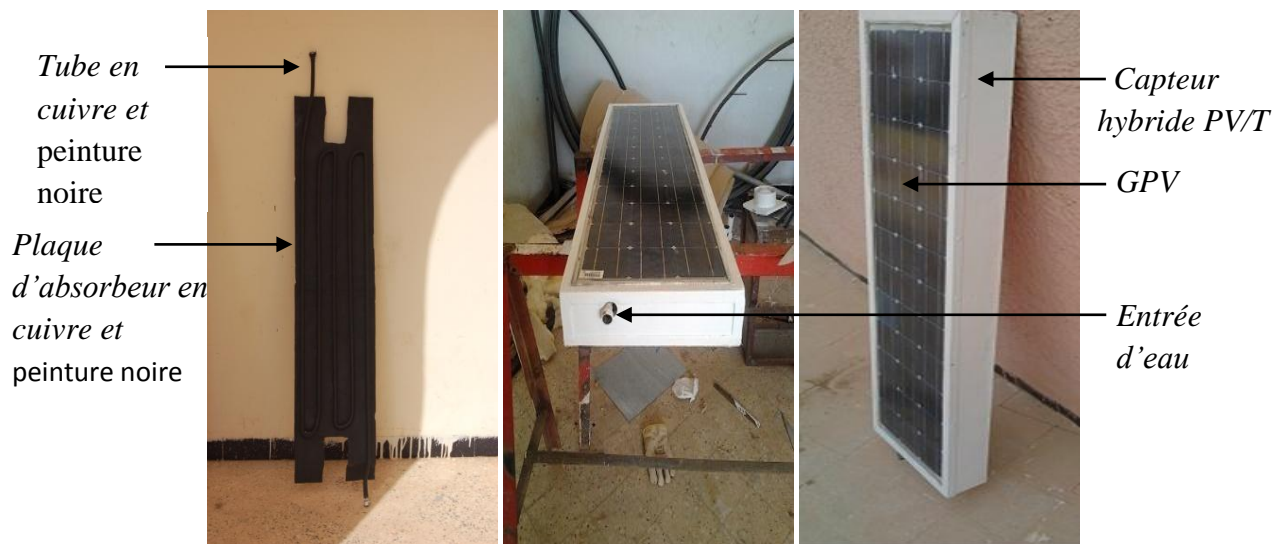
Figure IV.1. Prototype du capteur solaire hybride PV/T classique réalisé à URAER, CDER, Ghardaïa
