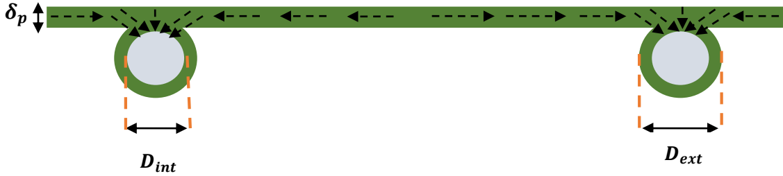
Figure III.4. Coupe transversale de la distribution de chaleur entre la plaque et le tube
