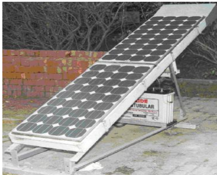
Figure I.20. Dispositif expérimental d'un capteur hybride PV/T à air réalisé par A.S. Joshi et al
