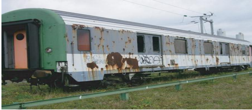
Figure 2.1 : Corrosion d'un wagon par l'action des pluies [18].
