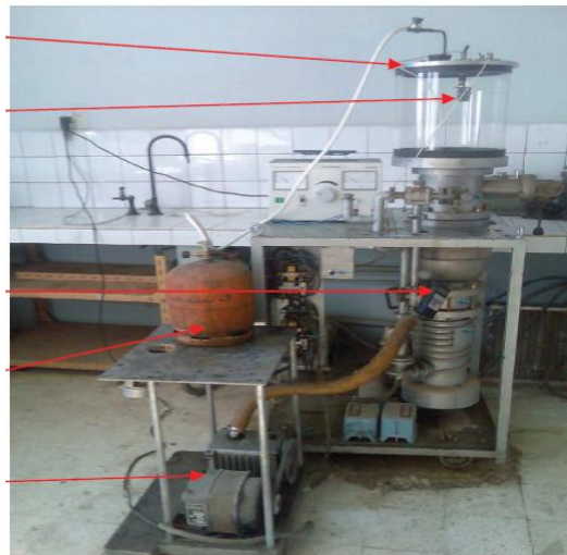
Figure 3.5: Dispositif du montage du traitement de surface
