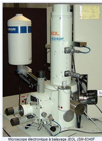
Figure 3 : Photo d'un MEB (à gauche), schéma d'un MEB équipé d'un détecteur de rayons X (EDS) (à droite)
