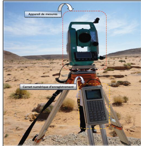
Figure I.7: Appareil de mesure topographique
