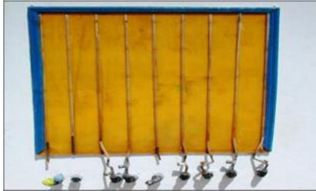
Photo V.11 : Tableaux manométriques de mesure des niveaux d'eau.
