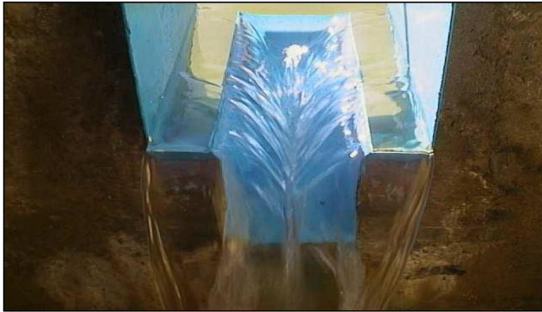
Photo III.01 : Écoulement en deux nappes déversante sur un cycle de PKW.
