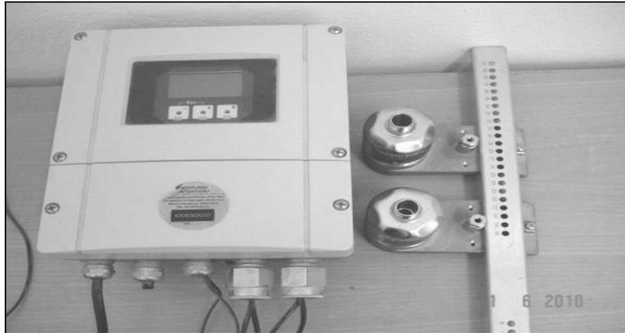
Photo V.12 : Débitmètre à ultrason Flowmeter 93W2.
