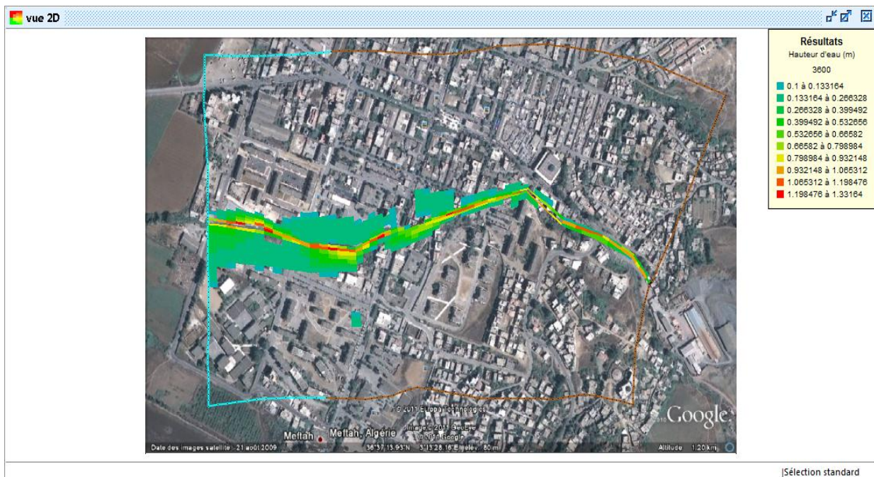
Figure V.11 : Etendue de la crue a t = 3600s
