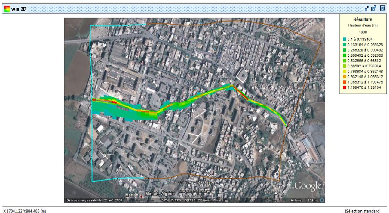
Figure V.10 : Etendue de la crue a t = 1800s
