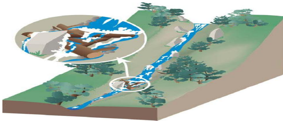
Figure I.5 : Embâcle sur un torrent
