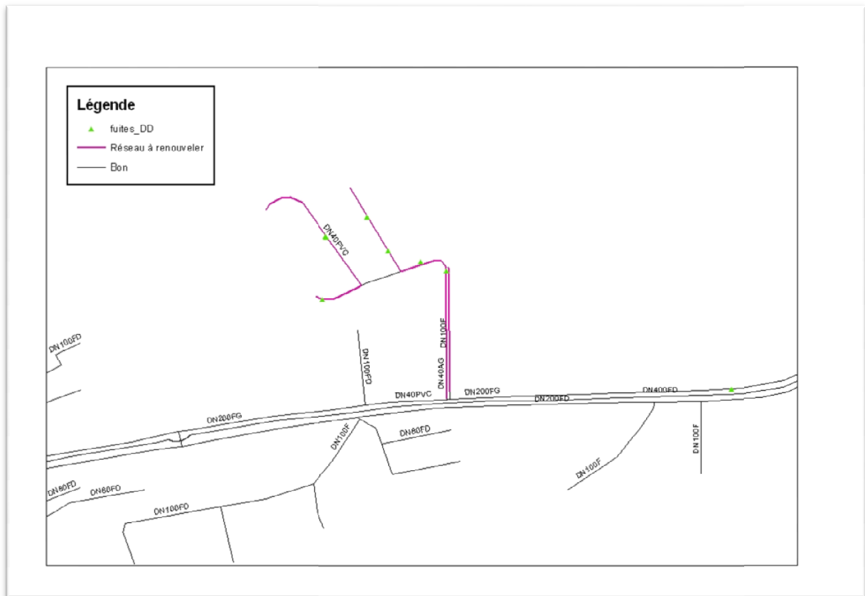
Figure IV-44 : Carte représentant une partie des conduites à renouveler dans le réseau d'Alger
