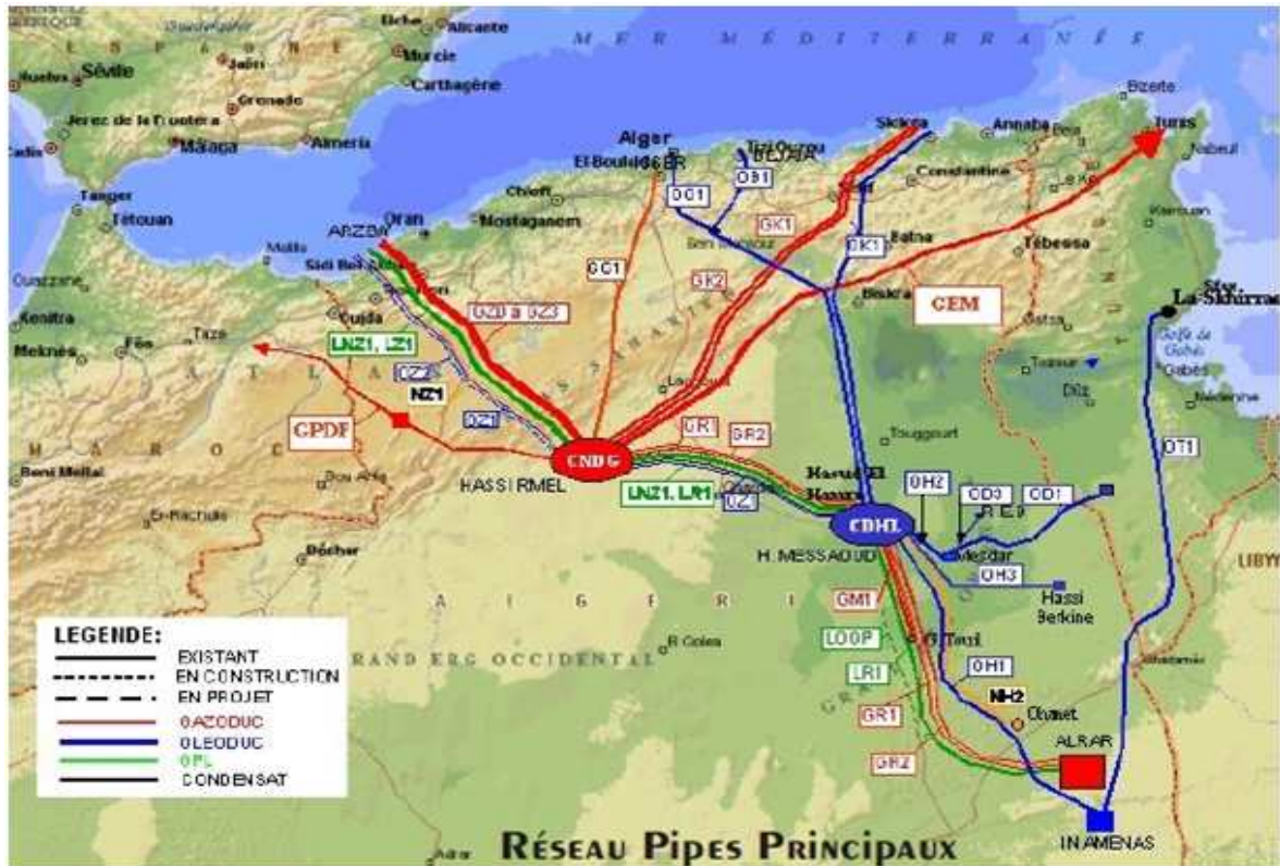
Figure 2 : Répartition du réseau de transport de canalisation
