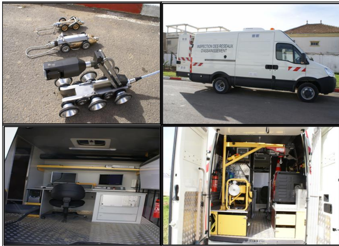
Figure 7 : Matériel d'inspection télévisée (en haut à gauche: caméras, en haut à droite: fourgon, en bas à gauche : poste de pilotage, en bas à droite : poste chantier)
