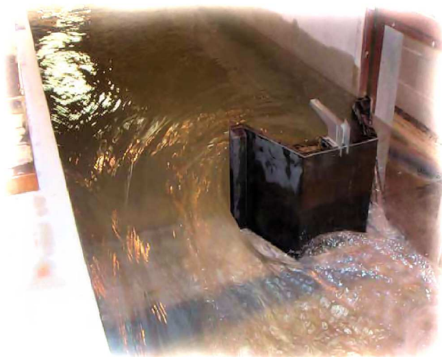
Figure (2.3.4) : simulation de l'écoulement après un premier basculement.
