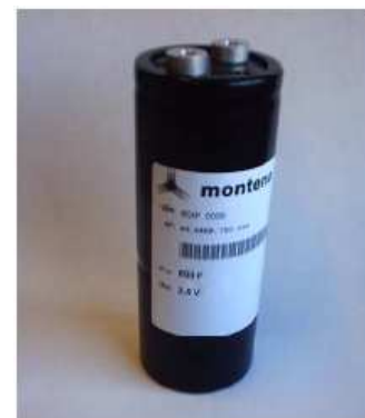
B. ECDL Supercondensateur 800 F / 2.5 V E = 2 500 J
