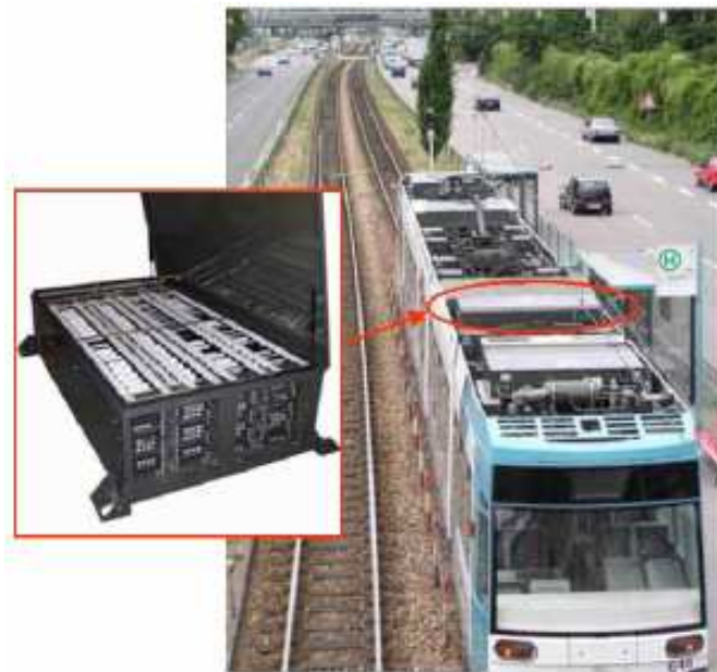
Fig. I. 17 : Prototype du tramway fabriqué par BOMBARDIER avec l'utilisation du supercondensateur comme alimentation secondaire [5].
