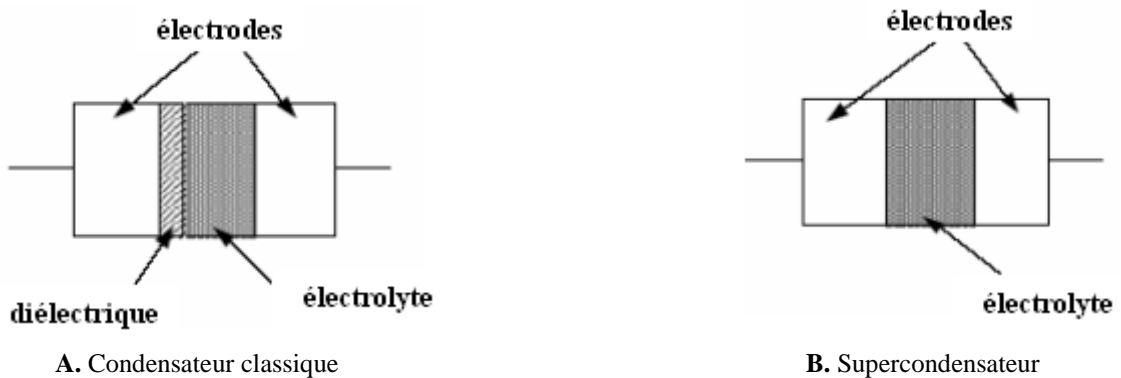
Fig. I. 5 : Différence entre un supercondensateur et un condensateur classique [9].
