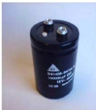
A. Condensateur électrolytique 100 000 \mu F / 16V E = 12,8 J
