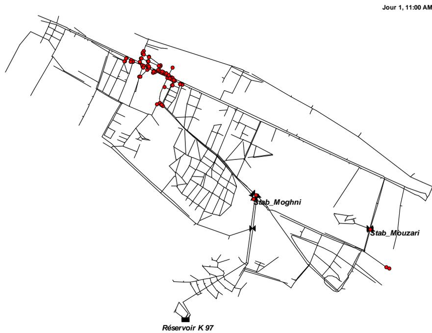
**Figure 1.9 :** Pressions supérieures à 60 m dans le réseau (à 11 :00) avec réduction de pression.
