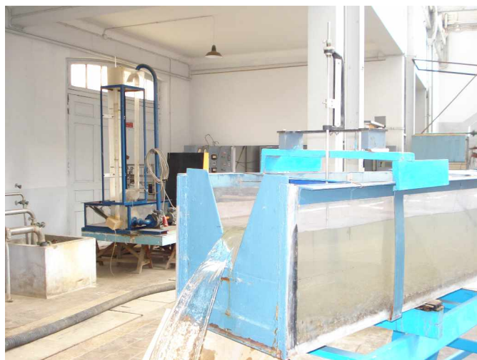
Photographie IV-5 : Déversoir triangulaire
