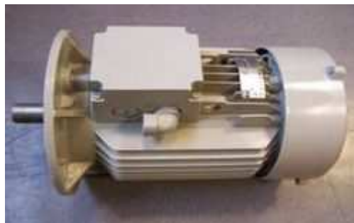
Fig 4.10. Machine asynchrone 8 kW
