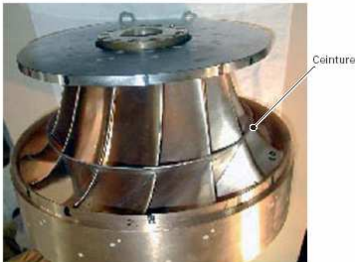
Figure 3.8 : Roue Francis model modifié par Alstom
