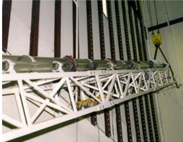
Figure II.10: Conduite expérimentale inclinée [13]
