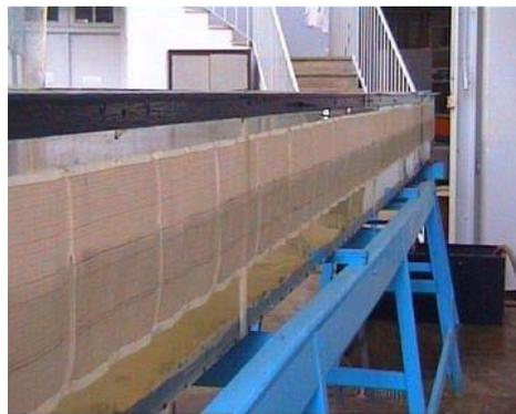
**Photographie IV-6** : Dispositif de mesure de la hauteur d'eau (Papier millimétré).
