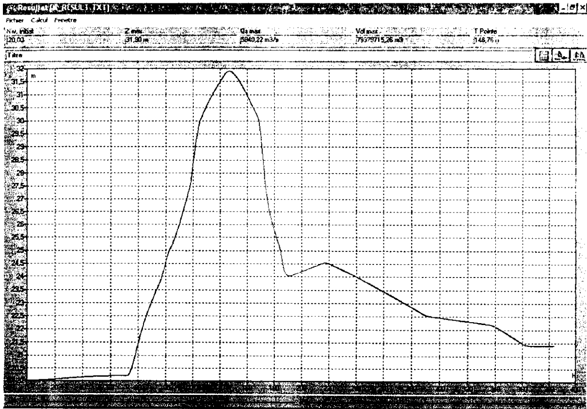
FigureVI-14 Evolution de la hauteur d'eau en fonction du temps
