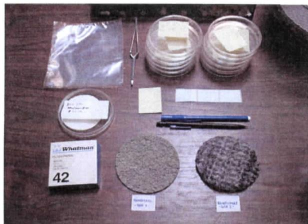
Figure 18 : Matériels utilisés pour la technique du papier filtre
