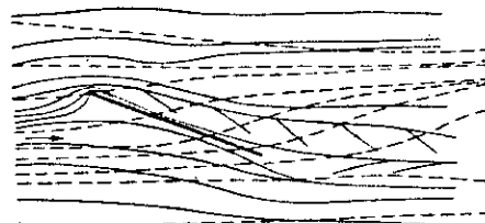
ESSAIS EN CANAL: Lignes de courant
