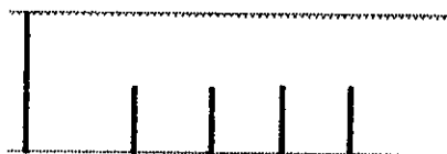
Figure (5.3) : Variante 2, disposition en forme d'épis
