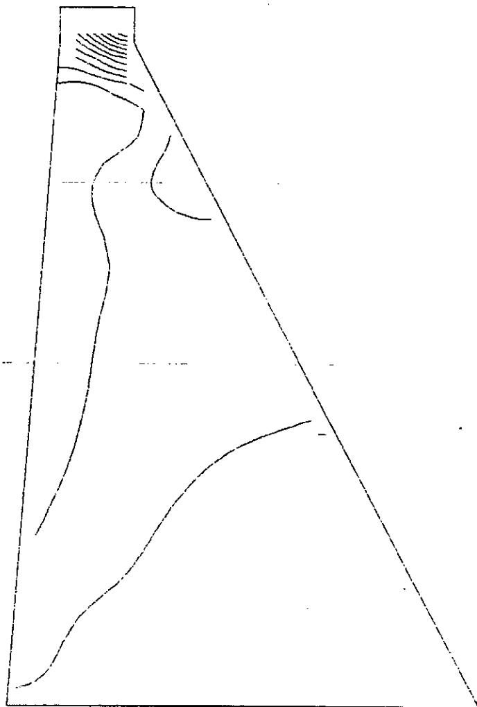
- Fig 1.3.3 - courbe d'isocisaillement taux \max(n/m+m) cas de retenue pleine sans seisme (cp)
