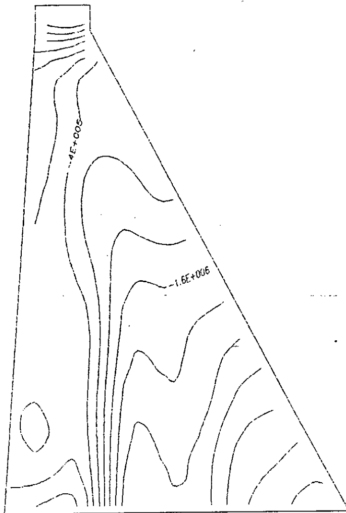
-fig 2.2.2- courbe d'isocontraintes sigma min(n/m*m) cas de retenue pleine avec seisme horizontal (dp)
