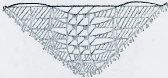
FIG. 13. Diagramme de déformation du barrage de Stevenson-creek.
