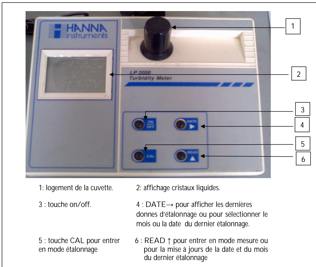
Figure IV-1 : Schéma d'un turbidimètre
