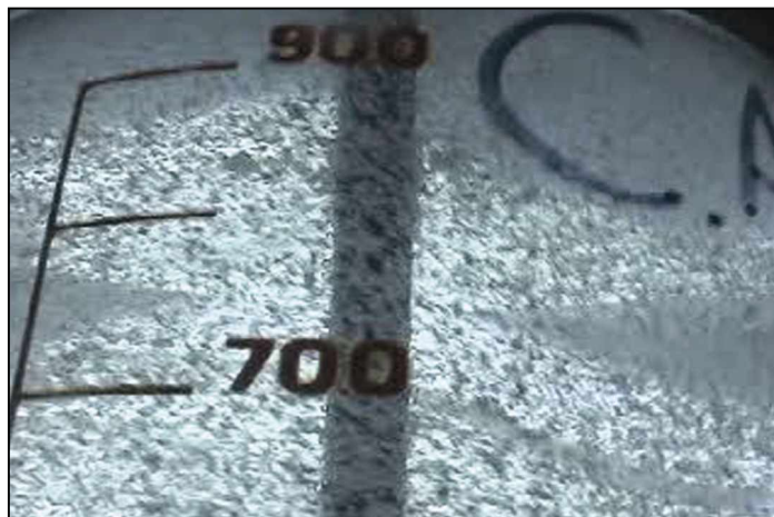
Figure V-10 : formation de floc par l'application du chitosane
