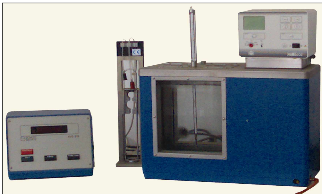
Figure IV-2 : Schéma d'un viscosimètre
