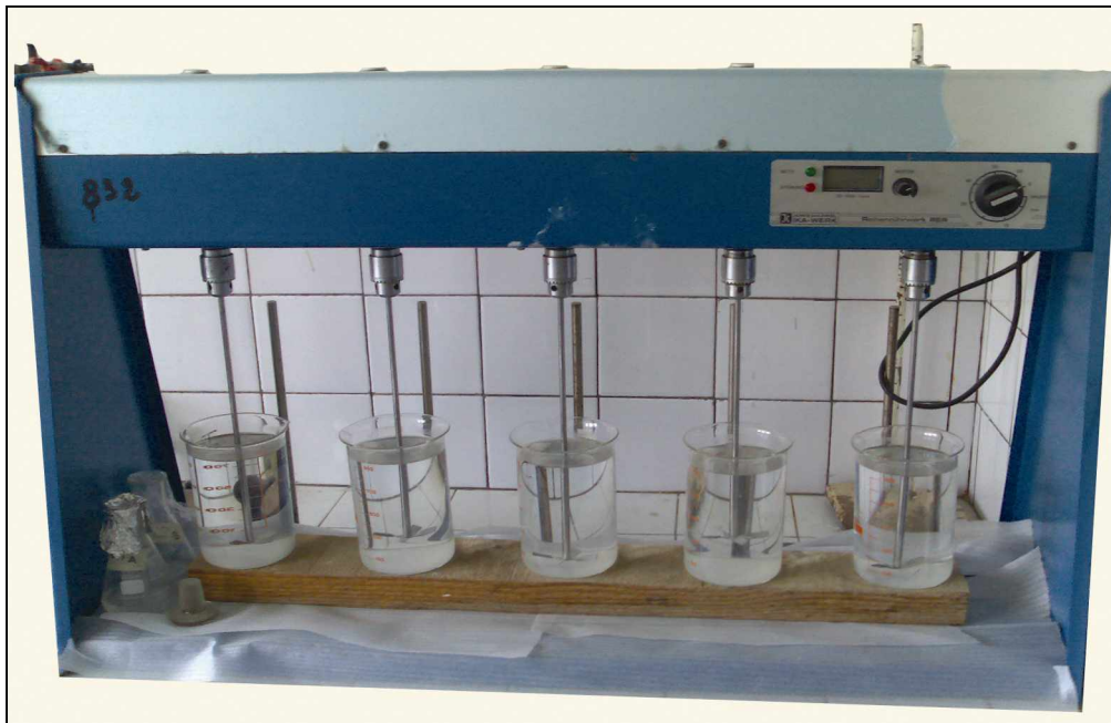
Figure IV-3 : Schéma d'un flocculateur (jar test)
