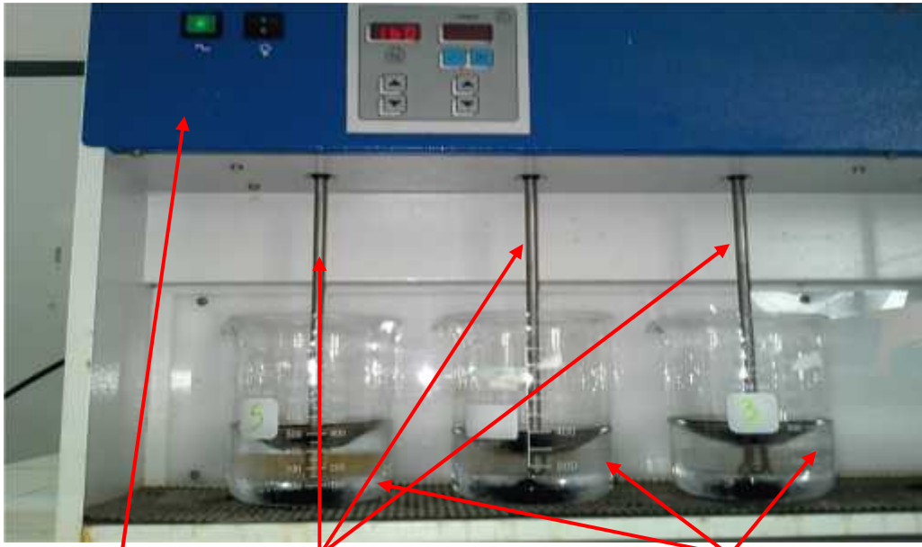
Figure n°IV.1 : Dispositif des essais d'adsorption.
