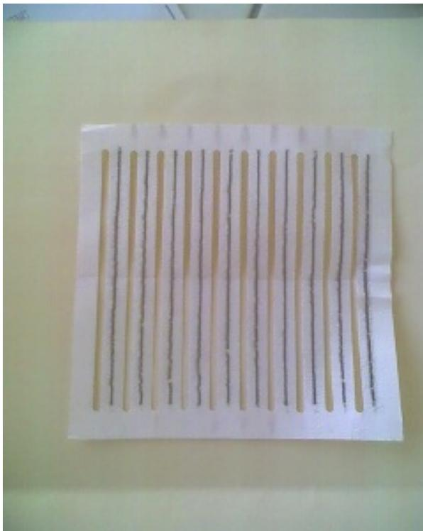
**Figure N°12 :** Photo d'un filtre de fractionnement granulométrique après prélèvement.
