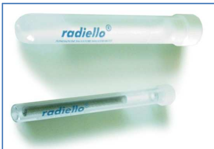
Figure n° 25 : Cartouche adsorbante Radiello.
