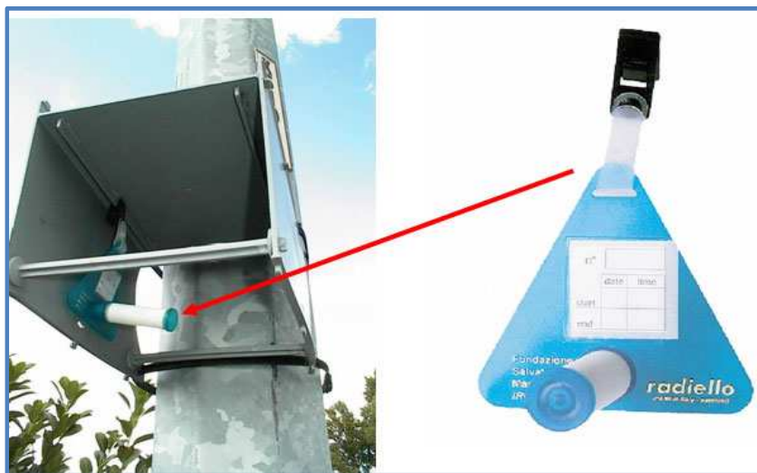
Figure n° 28 : Echantillonneur Radiello dans son abri.
