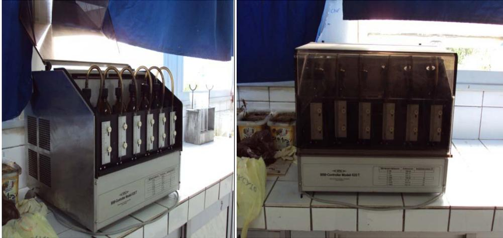
**Figure II-2 : DBO-mètre.**
