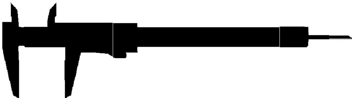
**Figure IV.2 : Pied à Coulisse \_ système métrique [72].**
