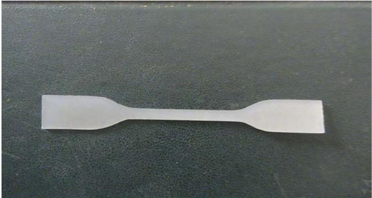
Figure IV.6 : Eprouvette haltère pour essai de traction.
