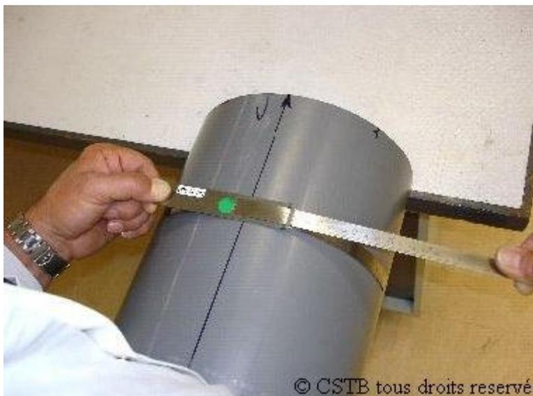
Figure IV.1 : Circomètre [71].
