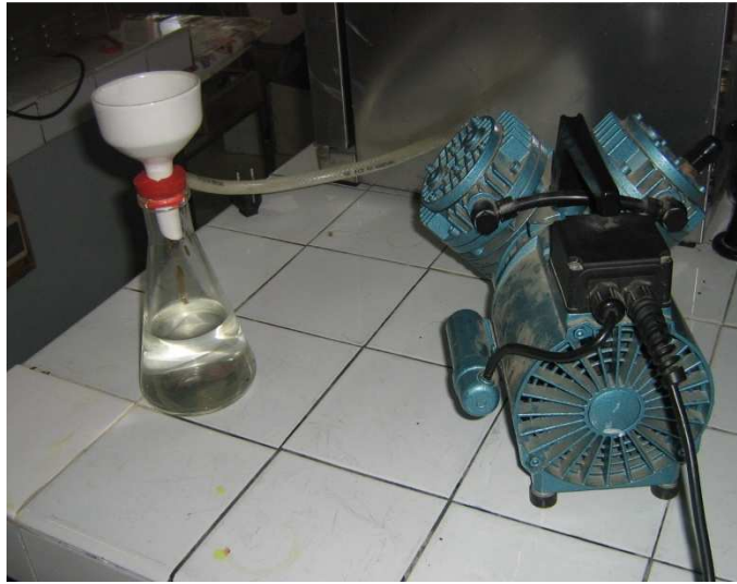
Figure 8 : Dispositif utilisé pour la filtration sous vide.
