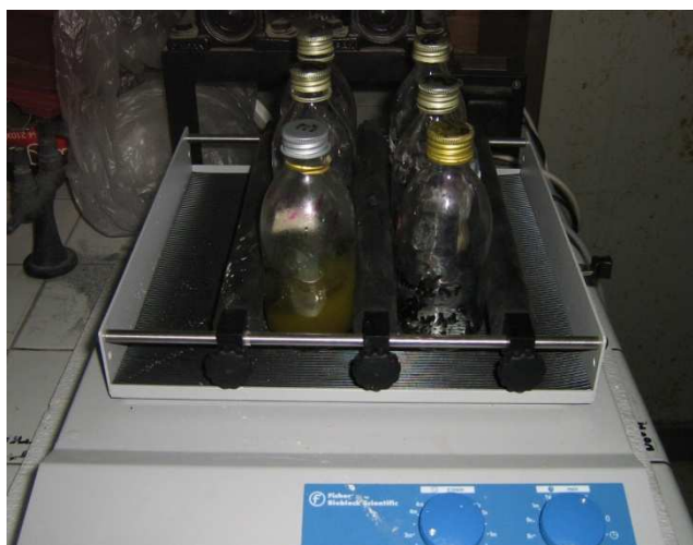
Figure 7 : Dispositif utilisé pour l'adsorption et la régénération.
