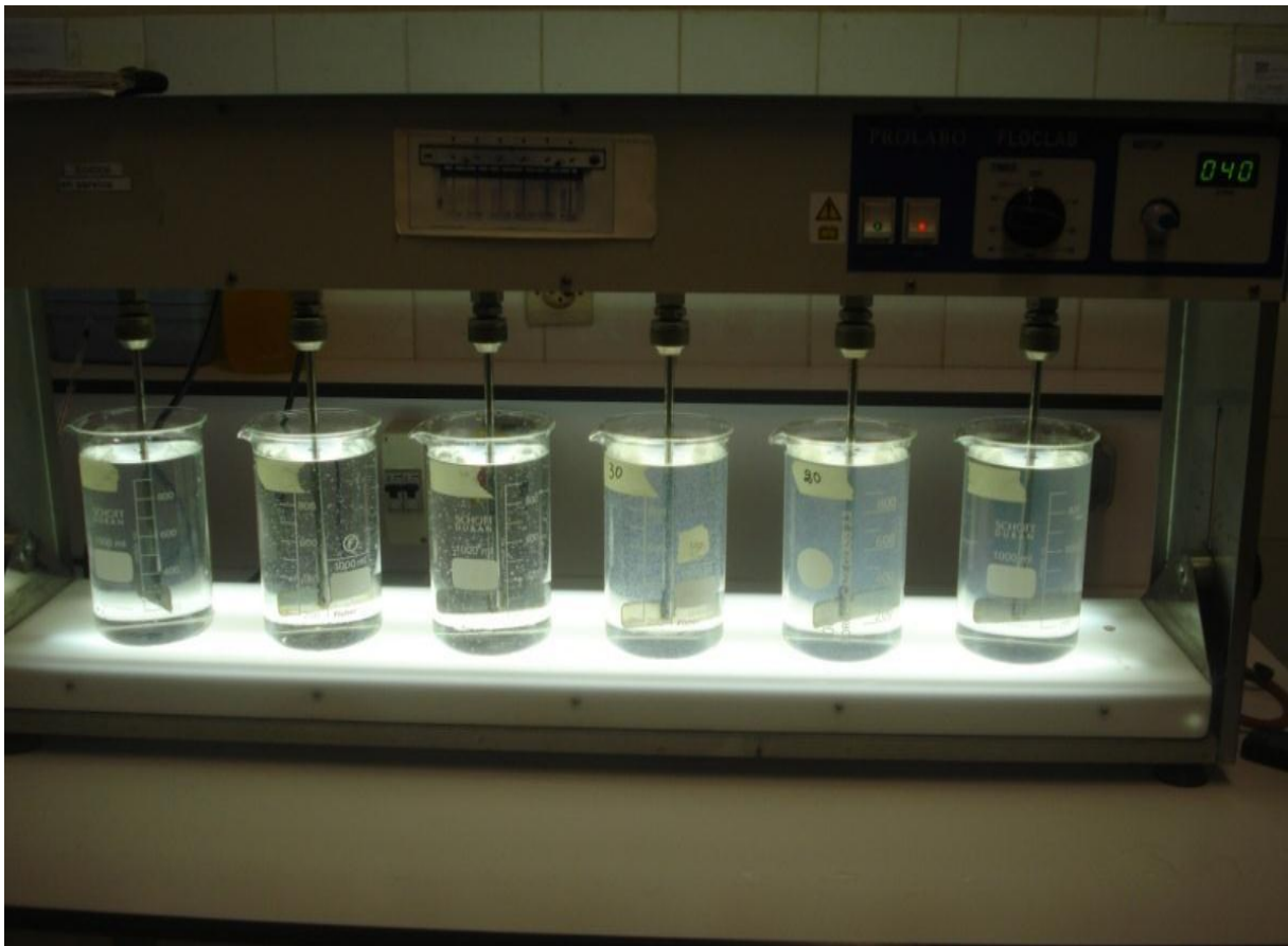
Figure IV.1: Floculateur (Jar test)
