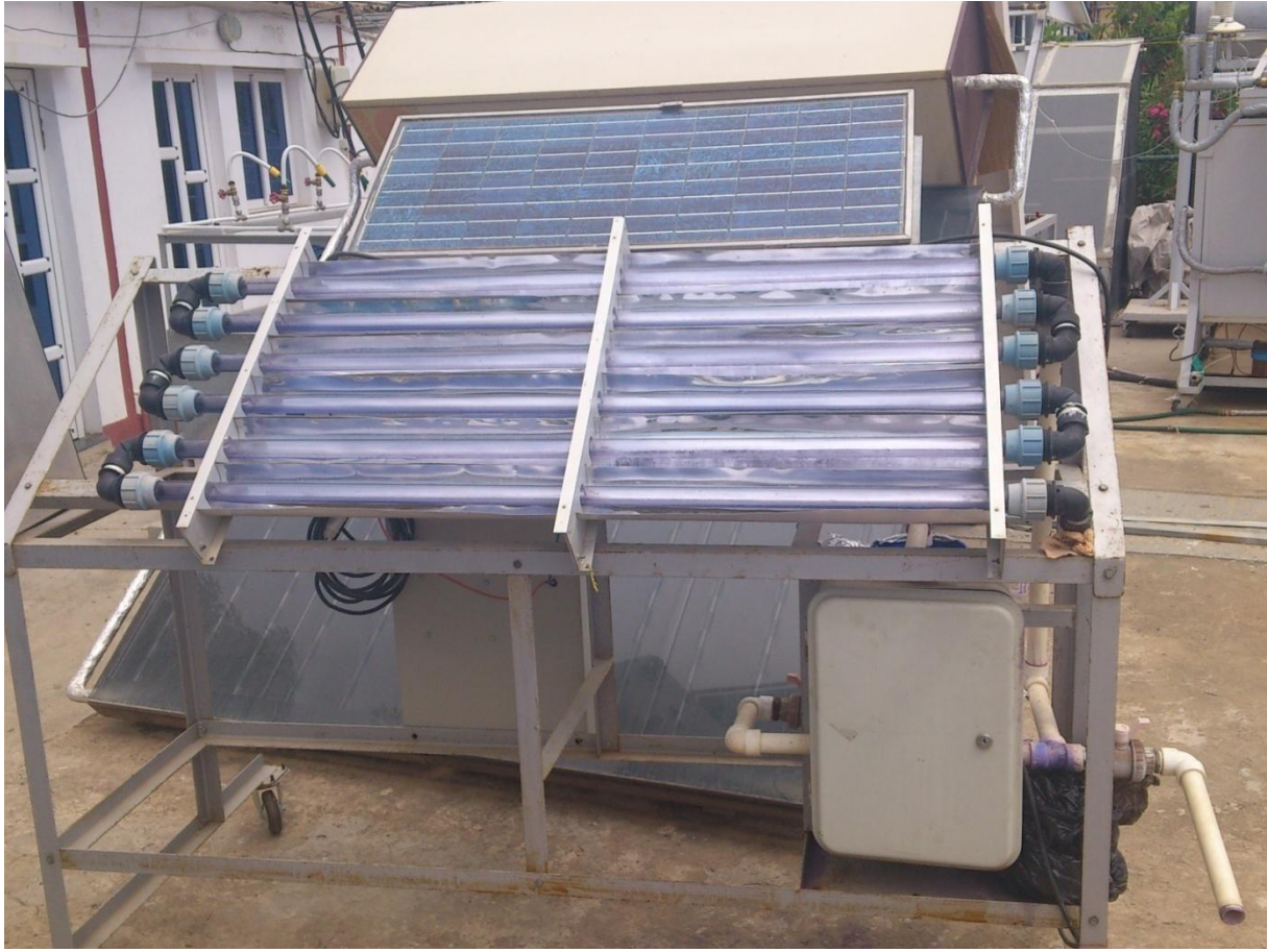
Figure 12: Réacteur CPC pilote utilisé lors des manipulations au CDER.
