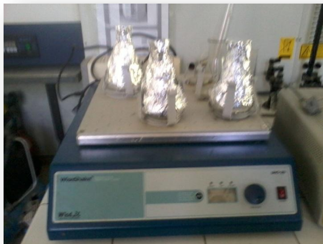
Figure 10 : Dispositif d'extraction en mode Batch
